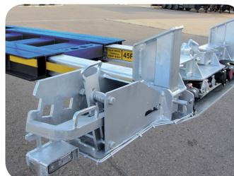
Opción: Extensión delantera frontal para carga de contenedores 45' y cajas móviles dentro de los máximos legales permitidos (sin permiso especial para el transporte). Altura de cuello de 150 mm. Deslizamiento de extensión guiado mediante rodamientos y placas de teflón. Galvanizado del conjunto completo de extensión para asegurar su conservación.
