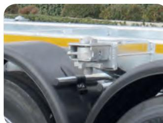
Opción: Twistlock adicional plegable que permite la carga de un contenedor avanzado de 20', lo que aumenta la distribución del peso en el eje de transmisión del tractor.
