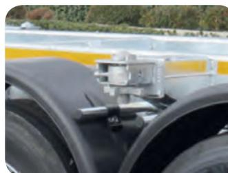
Opção: Twistlock adicional, rebatível, que permite a carga de um contentor de 20' avançado, aumentando a distribuição de pesos no eixo motriz do tractor.
