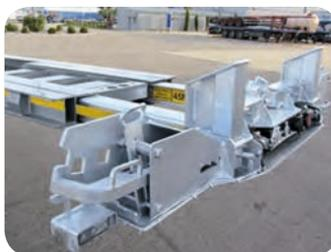
**Opzioni:** Allungamento frontale anteriore per il carico del contenitore da 45' nel rispetto delle massime dimensioni per la circolazione senza permesso speciale. Lo scorrimento è guidato da cuscinetti e piastre di teflon. Per una perfetta durata nel tempo questa parte è in acciaio zincato.
